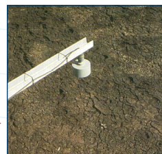
سنسور بدون تماس اولتراسونیک در محل نصب
